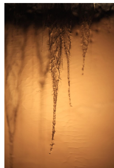
図 5：0.01g/cc 疎水性エアロゲルに捕集された、5.5km/s 程度で衝突したペプチド含有モンモリロナイト鉱物粒子
