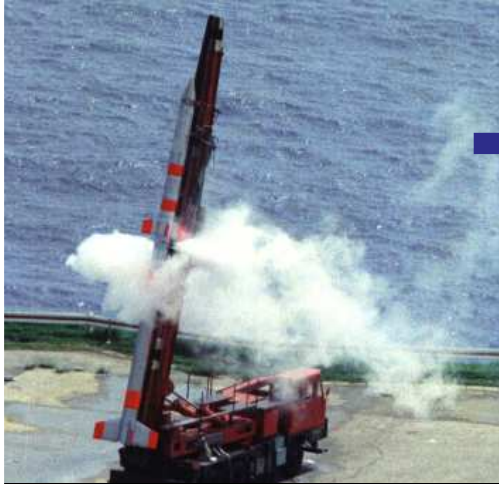
過酸化水素漏れで激しく反応
