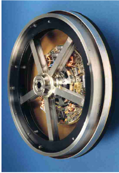
図 5-4 RSI-68 外観図及び内部構造
