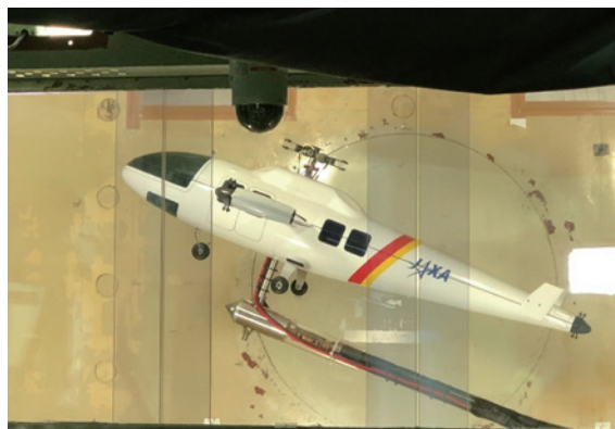
図 13 コンパウンド・ヘリコプタ模型の風洞試験の様子
