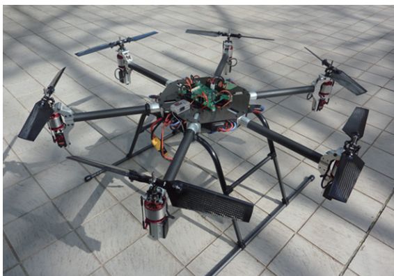
図 14 可変ピッチ制御の マルチロータ型ドローンの開発例
