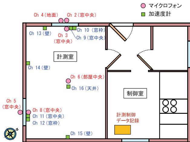
図5 計測小屋付近および内部のセンサ配置
