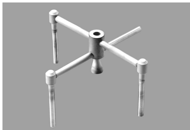
図 7.2 単結晶モリブデン製超小型太陽熱スラスタの写真
