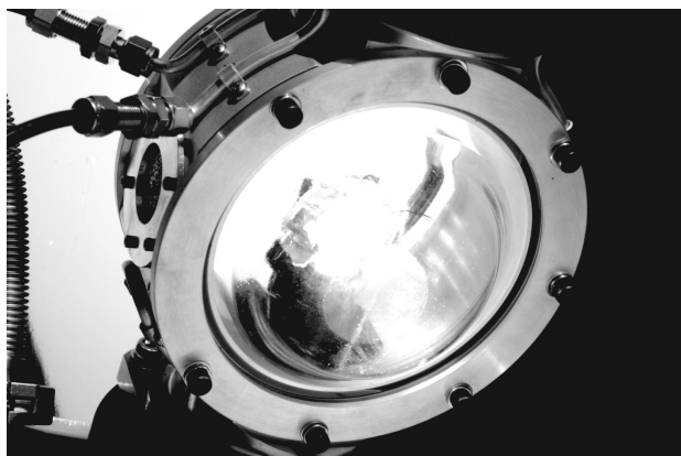
図 9.8 SUS 316 製対向型スラスタの加熱実験の状況
