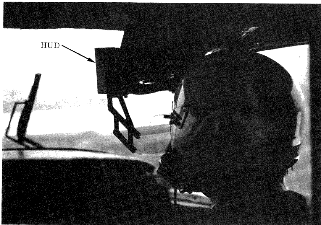
図 4.8.3-3 QUEEN AIR 機の操縦席に付けられた HUD
