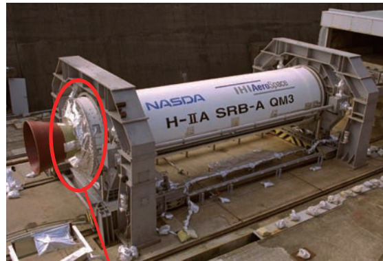
耐熱カーテン基材（シリガラスのアルミ蒸着）
