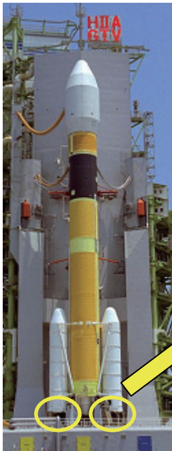
H-IIAの固体ロケットブースターのノズル及び周辺部に耐熱性・断熱性に優れたシリガラスを利用
