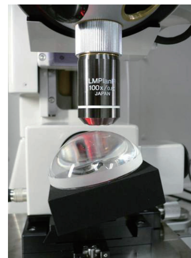
レーザプローブ式三次元測定器
