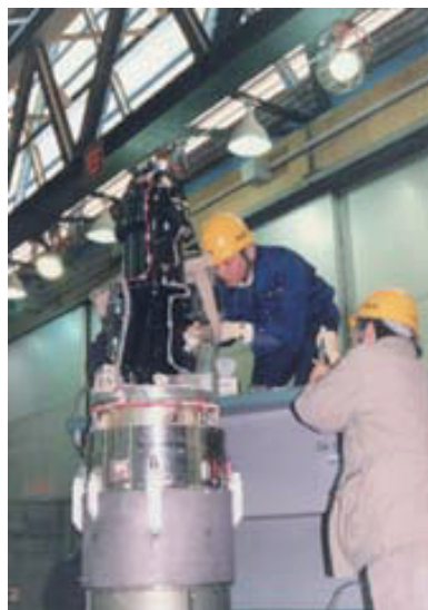
ロケットに組み込まれるXUV ドップラー望遠鏡(XDT)
