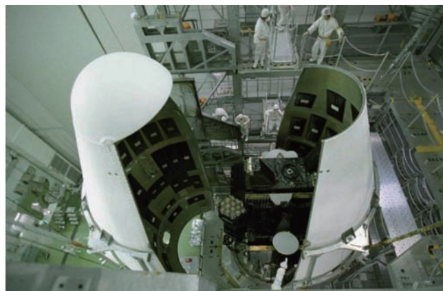
ロケットのフェアリング内に貼り付けられた防音ブランケット
