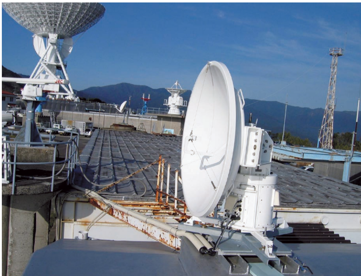
図2. 局地観測用気象レーダ（三菱電機特機システム㈱MDT-WR901） コントロールセンター屋上に設置されている。パラボラ有効開口径1.2m
