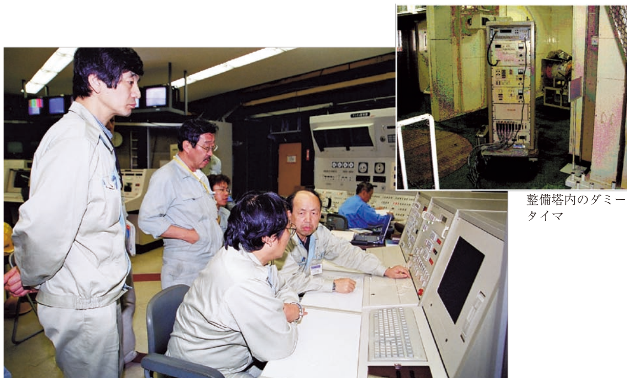
図4 ダミータイマを用いた点火タイマ管制装置の機能試験
