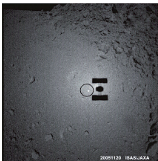
図2-2-4 着陸時に分離されたターゲットマーカと探査機の影
