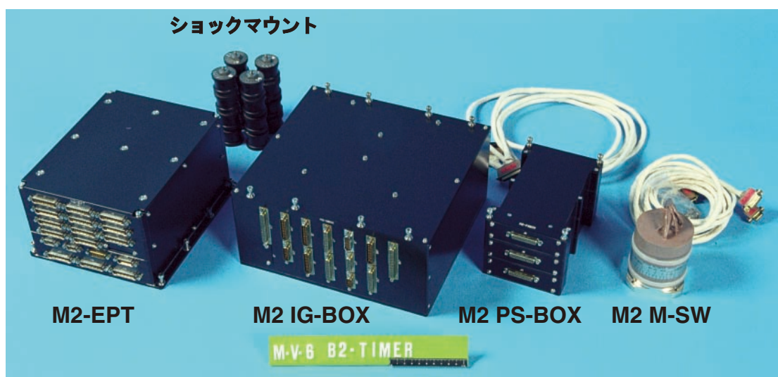
図2 第2段目計器部搭載のタイマ点火系機器 (M-V-6)
