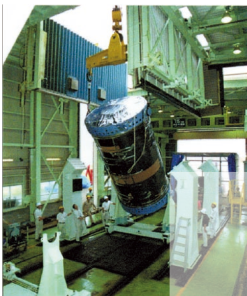
モータ吊込み作業
