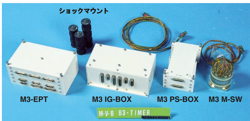
図3 第3段目計器部搭載のタイマ点火系機器 (M-V-6)
