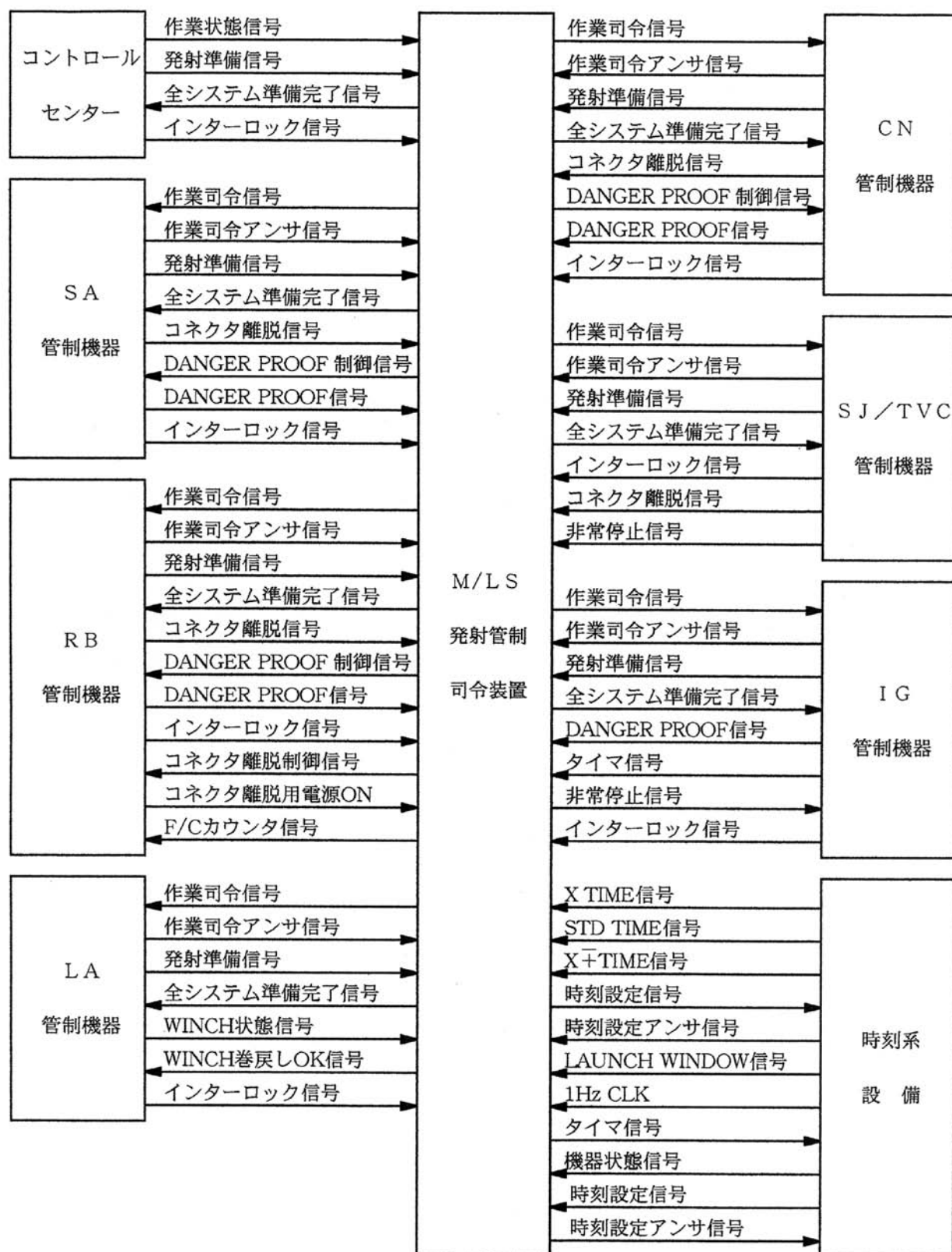
図1 M-Vロケット発射管制設備インターフェース系統図
