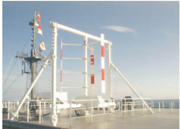
図 2 船用直線翼垂直軸型風力発電装置 “NWT - 30”
