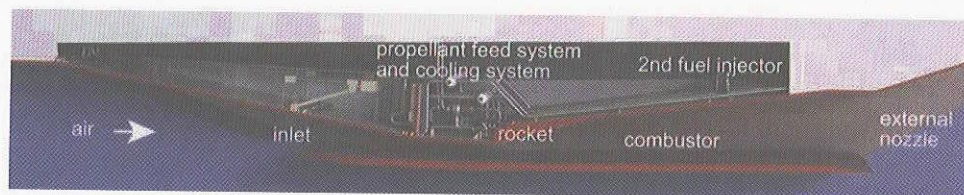
図1 複合エンジンの概念図
