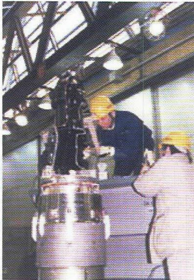
ロケットに組み込まれるXUV ドップラー望遠鏡(XDT) 1999年1月に固体ロケット S520-22号機で打上げられた、
