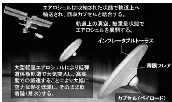
図1：インフレータブルトラスで支持された薄膜フレア型柔軟エアロシエルを利用した大気圏突入機の概念図
