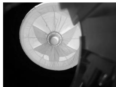
図4：ロケット搭載カメラで撮影した射出 4 秒後の実験機の様子
