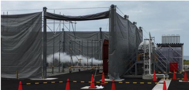
第2図 実験設備から高压液化水素が噴出する様子
