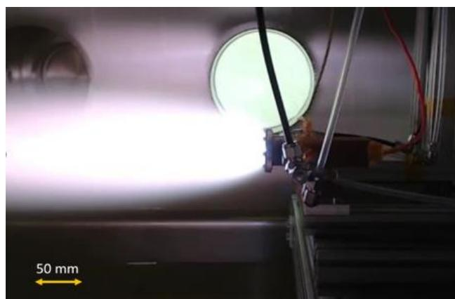
図6 アークジェット推進機の作動時の様子
