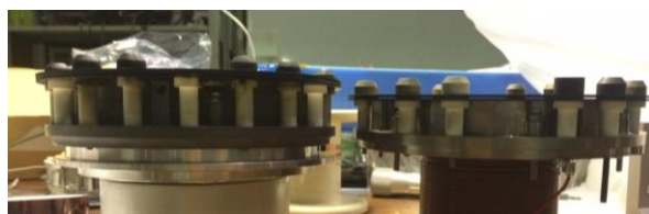
図2 ノミナル支持リングと短グリッド支持リング
