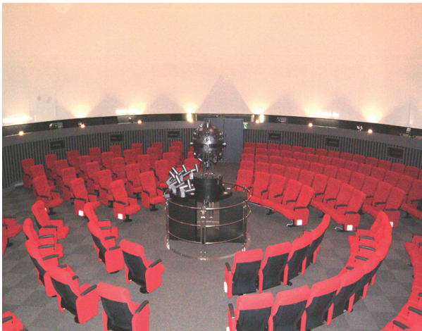
図－1 典型的なプラネタリウムの例 ドームの中心には主に星像を投影するアナログ（光学）投影機（プラネタリウム本体）、周辺にはドーム映像を投影する機材が設置されている。この写真は、旭川市科学館サイパル（2005 年開館、ドーム直径 18m）の例。
