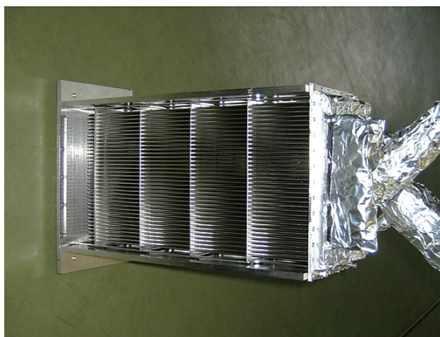
図 10 熱交換器写真 (上：蒸発器，下：プリクーラ)
