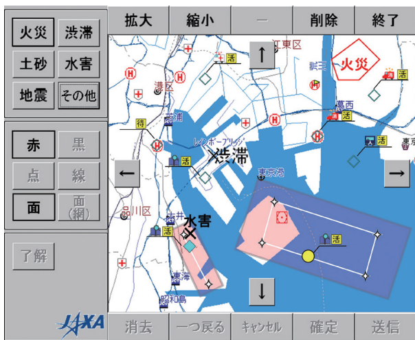
図5 機上端末の表示・入力画面の例
