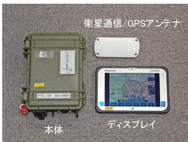
図5 機上端末の表示・入力画面の例
