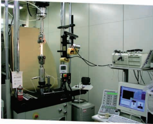
図A3.1-1 室温 引張試験 全景
