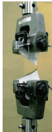
図A3.3-3 破断例
