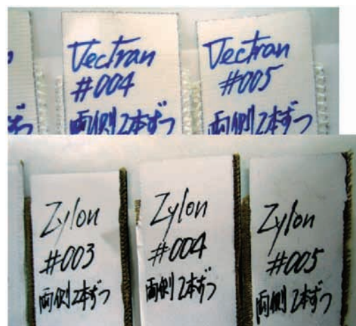
図18 糸引き後の引張試験供試体
