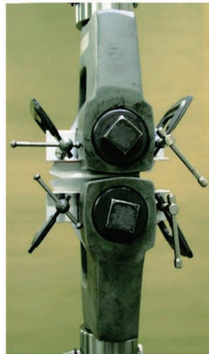
図23 トラペゾイド試験の供試体取付け状況
