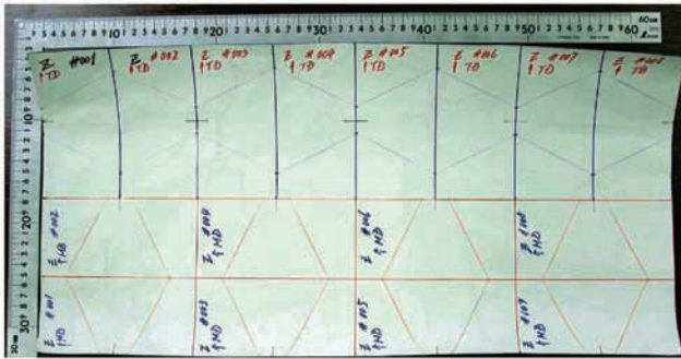
図20 トラペゾイド試験供試体の罫書き
