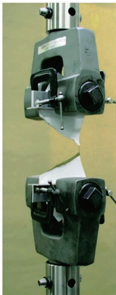
図25 トラペゾイド試験の供試体破断後状況
