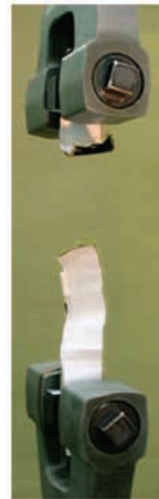
図A3.1-2 破断例
