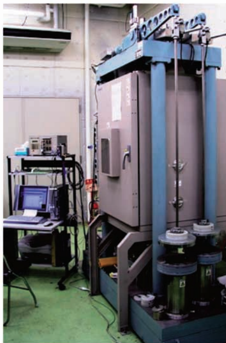
図A3.2-1 65°C Creep試験 全景
