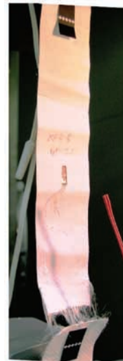
図A2-2 供試体破断後
