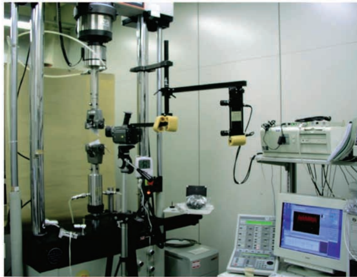
図A3.3-1 室温 引裂き試験 全景
