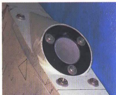
(d) トランスポンダアンテナ (ロケット No 3 安定翼端)
