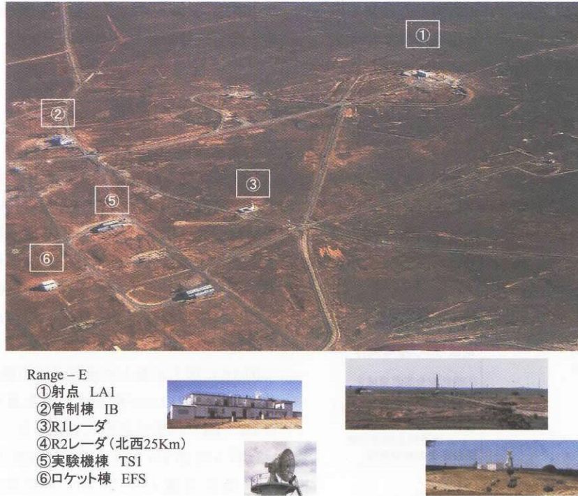
図 3.2 Range-E 地上設備配置
