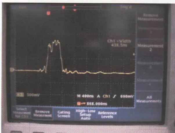
図 A.2-9 パルス幅 (First Pulse)
