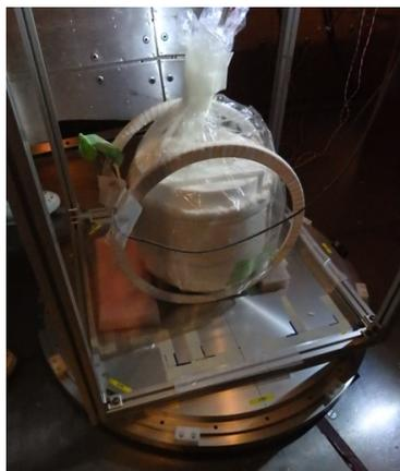
写真 7: 低温側セッティング。保温瓶はドライアイスの気化により発生する CO<sub>2</sub> を抜くための小さな穴を除き、密閉されている。
