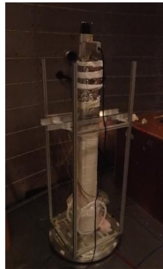
写真 6: 高温セッティング。保温瓶にパイプが取り付けられている。
