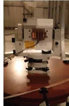
写真 2: MGF-S を取り付けた回転台。この写真では設定  $K^3$  に設定されている。アライメントミラー (センサミラー) は写真左上の回転台に取り付けられている。
