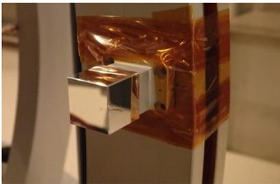
写真 3: 印加コイルに取り付けられたアライメントミラー (コイルミラー)
