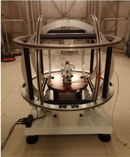
写真 1: 較正用印加ヘルムホルツコイルとその中心に設置された回転台。回転台には MGF-S が取り付けられている。
