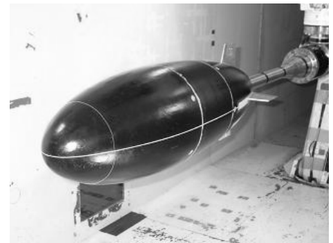
図 2-1 風洞内模型
