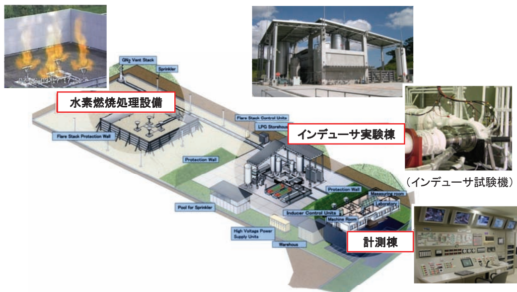
図5 極低温インデューサ試験設備（CITF）の鳥瞰図
