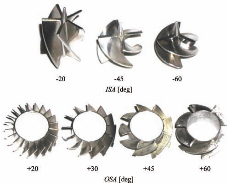
図2 インナースワラ及びアウトースワラの写真
