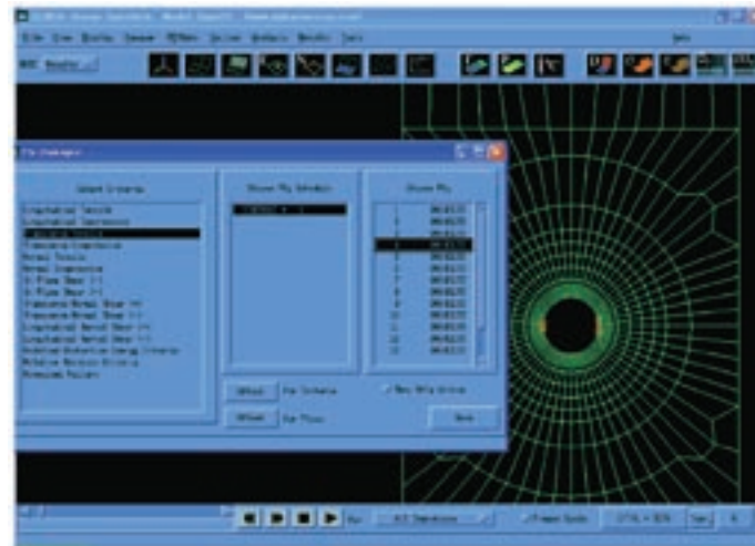
図6.8 層の損傷 (Ply Damage) 分布拡大図 (90°層のTransverse Tensile) (完全拘束, 初期損傷 (Damage) 発生 (150.1MPa) 時)
