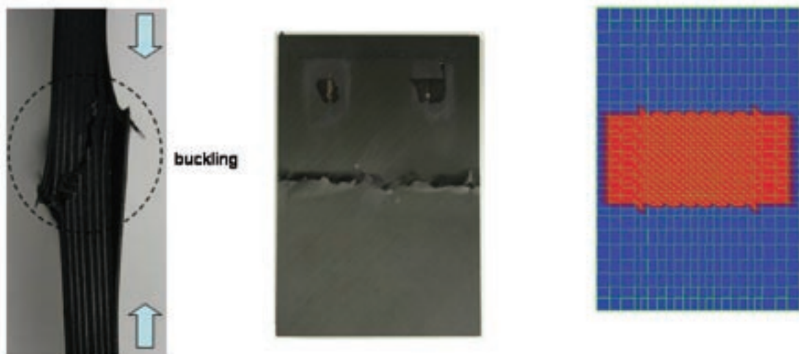
図 7.9 衝撃後圧縮（CAI）試験片の破壊状況と GENOA による解析の結果
