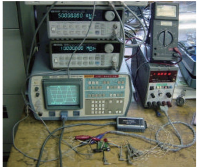
図4 AD変換動作確認試験の様子
