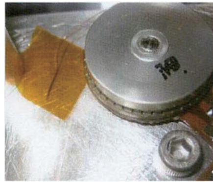
(b) USMと熱電対の固定状態
