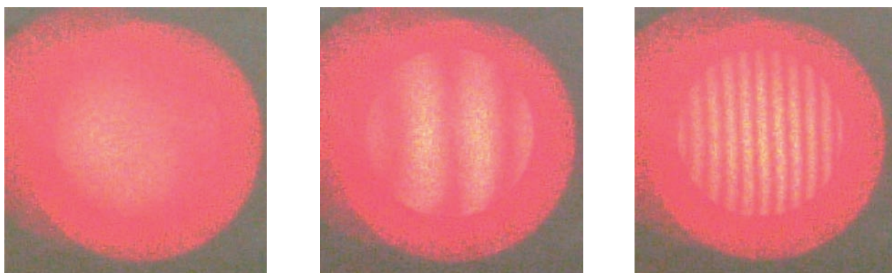
図15 第1回試験前の平面鏡の干渉縞
