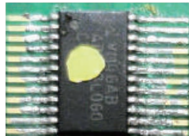
図1 月面環境試験後の素子概観。素子は2005年9月の試験にも使用。
