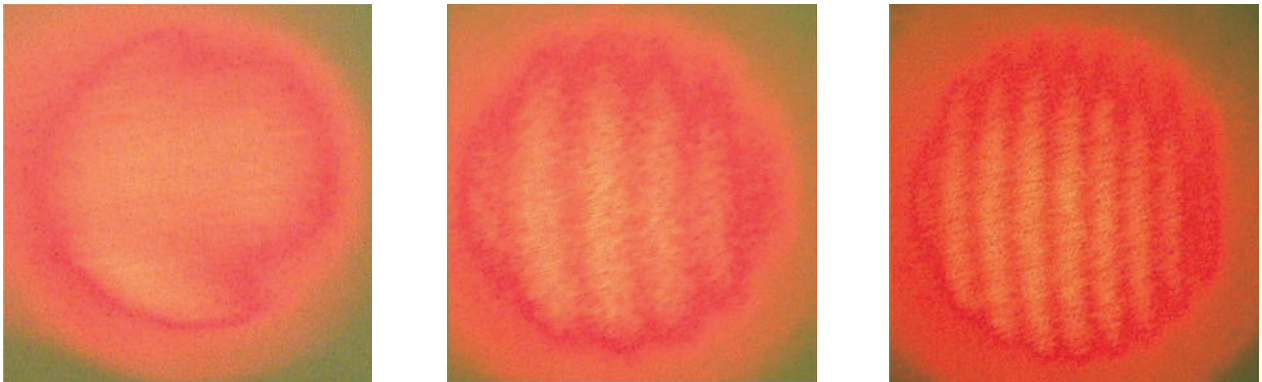
図16 第1回試験後の平面鏡の干渉縞
