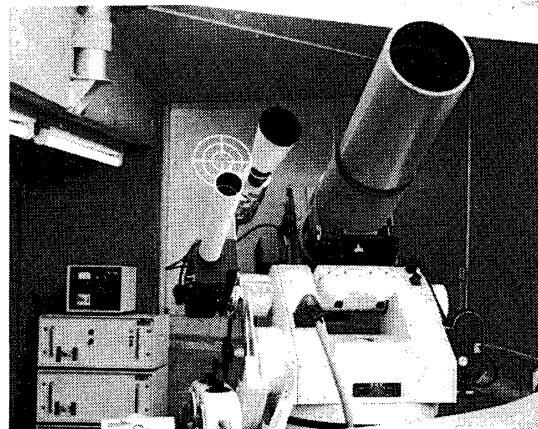
第12図 2000mm超望遠レンズ付自動追跡装置
