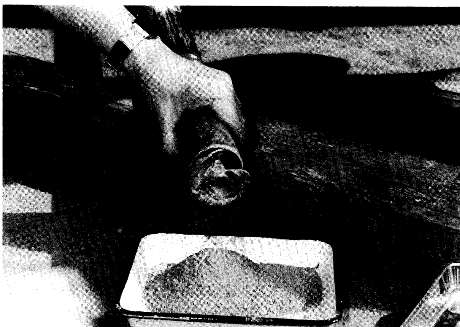
写真 5-4 横臥逆転により試料排出
