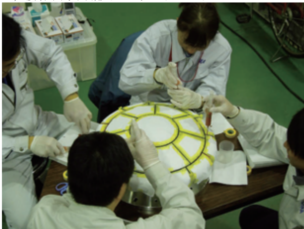
図 12 BBM ギャップ部の充填作業の様子
