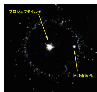
イジェクタによりMLIに生じた孔 (MLI最内層)
