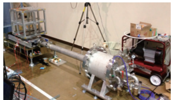
Fig. 2 衝撃試験装置 (MO バルブ型)
