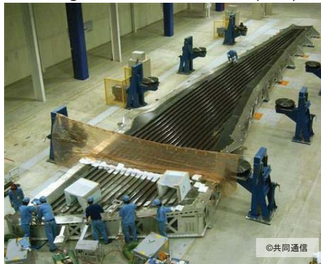
Boeing787の翼パネルの製造(MHI)
