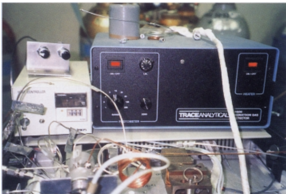
図 9 CO/ \text{H}_2 検出用 RGD2
