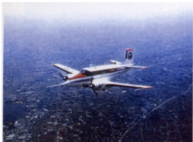
図2 航技研の環境観測用航空機クインエア (B-65)
