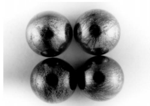
図15 試験後の軸受及び玉の外観 (試験 HAL-2)
