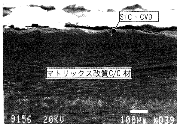
図10 マトリックス改質型断面SEM写真
