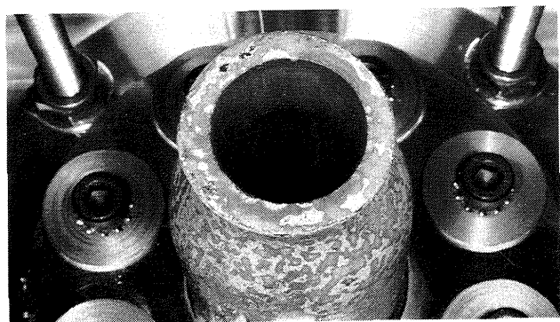
図28 燃焼試験 1 回後の従来型供試体外観
