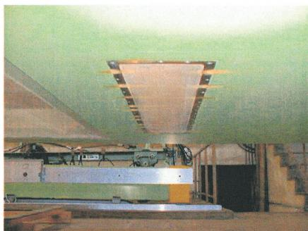
Fig.6 12m 模型船の空気吹き出し部(多孔質板)
