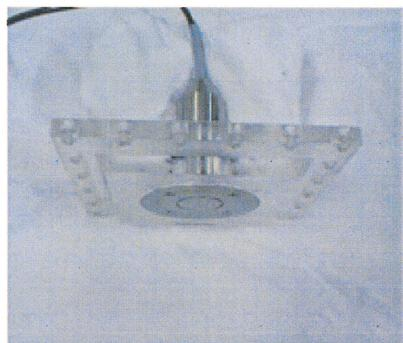
Fig.7 12m 模型船実験用せん断応力センサー
