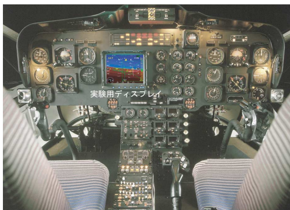
図 11 MuPAL-εのcockpitに装備された実験用ディスプレイ
