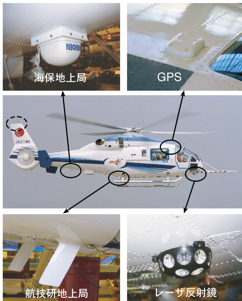
図5 DGPSシステムの各アンテナ及びレーザ反射鏡の搭載状況
