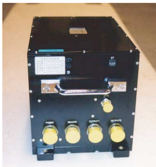
図3 DGPS/INS複合システム本体
