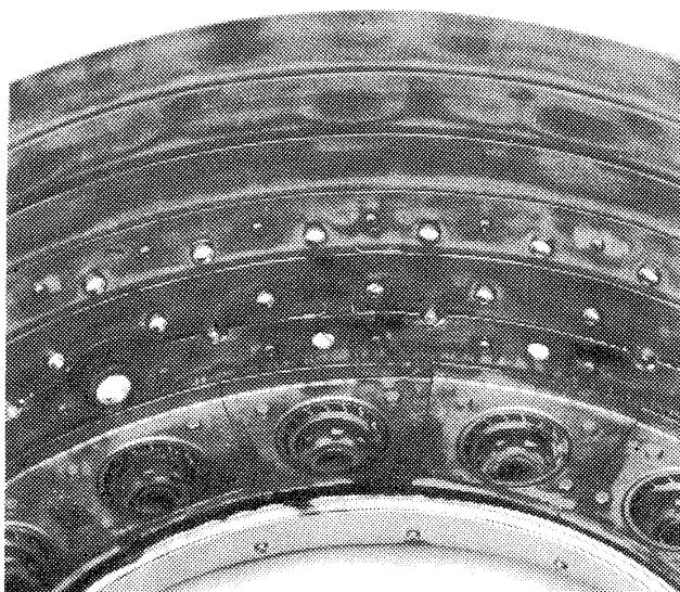
図 20 ライナ 63.01 の熱電対取付模様
