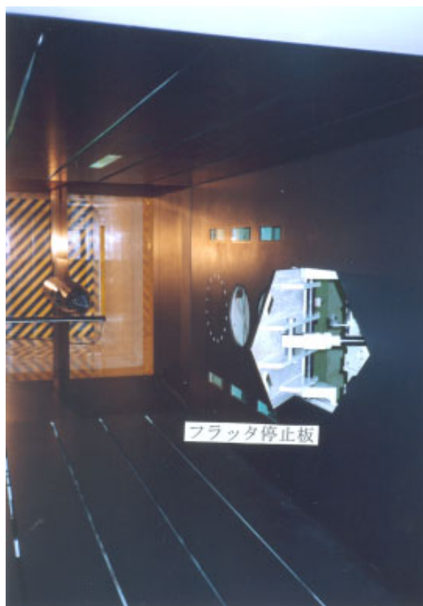
図8 開度41度のフラッタ停止板
