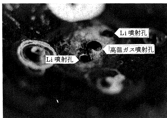
図 36 長秒時燃焼後の Li 噴射面
