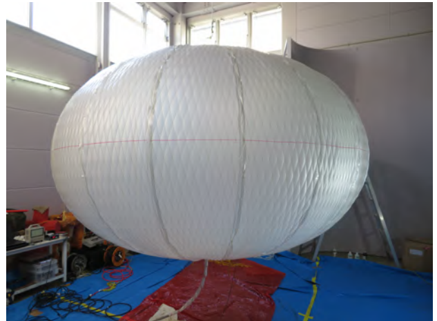
図 10: 2,000 Pa に加圧したゴム気球入り気球。
