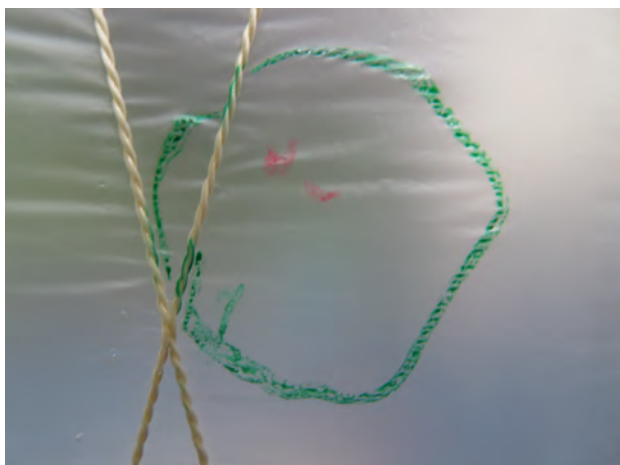
図 5: ガス漏れ箇所。目視では特徴はない。
