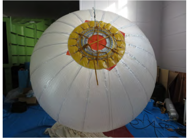
図 8: ウレタン布による気球頭部の保護。
