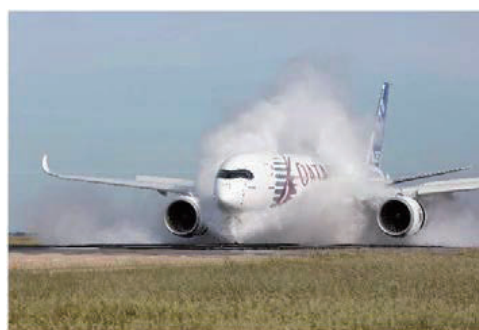
図 1 A350 の水跳ね試験 2)
