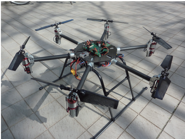
図6 可変ピッチ制御の6ロータ試作機 9)
