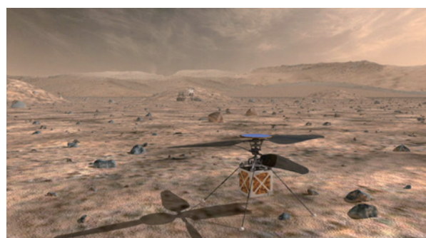
図4 NASA-MHで採用された2重反転ロータ型 7)
