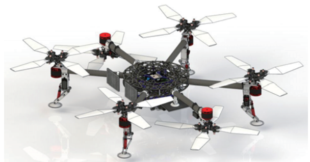
図11 可変ピッチ制御のHexa-Rotor型火星ヘリの概念図
