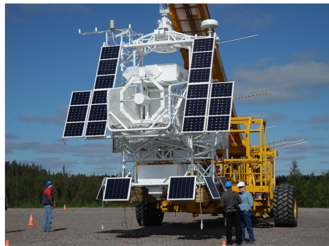
図1: (左)SUNRISE-2の望遠鏡とゴンドラ (右) SUNRISE-1/2フライト航路
