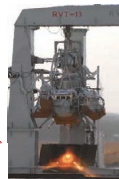
8 kN級ターボポンプ式エンジン (RVT-13)
