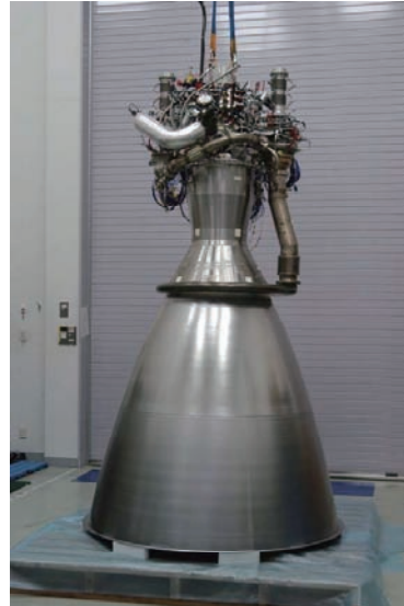
LOX-LNGエンジン(10ton級)
