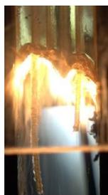
図5 燃え残ったポート壁面
