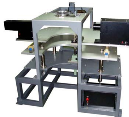
レーザー回折・散乱 粒子径分布・濃度測定光学系 + 並進・回転走査機構
