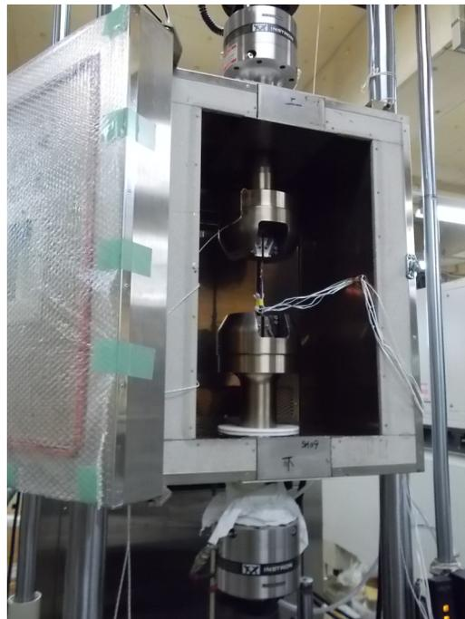
図 2.4 空気循環式低温環境槽付材料試験機
