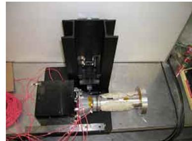
パイプに粘土を付加して質量を823gramから1179gramとすると、力の5000Hz～6000Hzの成分が通常よりも3～9倍に増大した。太陽電池パドルの慣性が力に影響する可能性がある。
