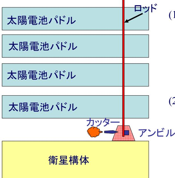
(1) 太陽電池パドルは、畳んでロッドで串刺しにし、そのロッドを保持解放機構が保持している。保持解放機構は衛星構体にボルト締結されている。
